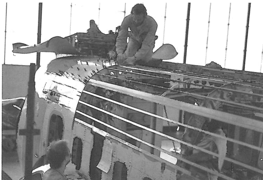
Det aller meste av vedlikeholdet utføres internt. Her gjør teknikere fra Plateverkstedet på Forus en større jobb på et Boeing Chinook-skrog.
