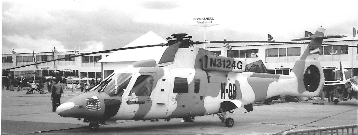
Sikorsky H 76 Fantail ble spesialbygd av Sikorsky og Boeing for å demonstrere det innebygde halerotor-systemet som ble utviklet for det amerikanske forsvaret.
