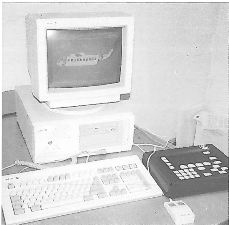
HUMS bakkestasjon (Stewart Hughes Ltd.) med PC og Data Retrieval Unit
