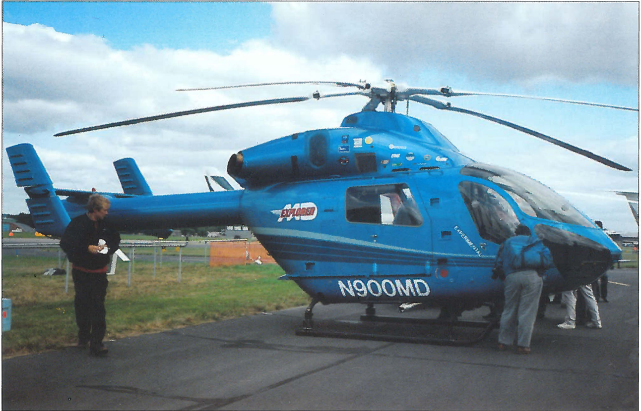
McDonnell Douglas MD900 Explorer, med notar-system i stedet for halerotor.
