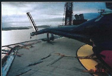
Godt at det var aluminiumsdekk! Rotoren gravde hull istedenfor å kaste maskinen utenfor
