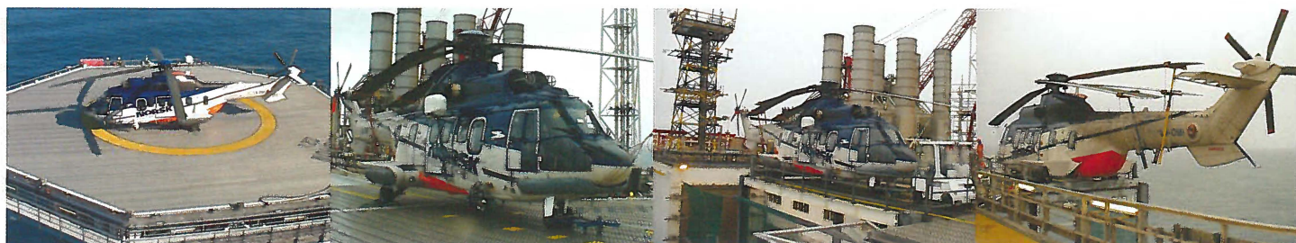
Folding av rotorbladene - Helikopteret heises ned og inn i hangaren på Heidrun.
