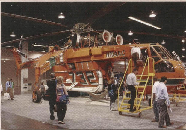
Et monster. Hver motor har 4500 shp. Maks gross er 42000lbs. Bare halerotoren har en diameter på nesten 5 meter. Og lengden på saken er 27meter fra bladtipp til halerotor.
