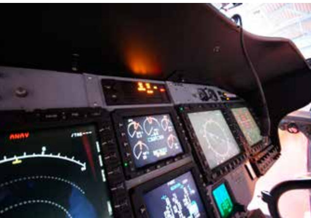
Utsnitt av EC225 cockpit med Warning and Caution midt i synsfeltet for pilotene
