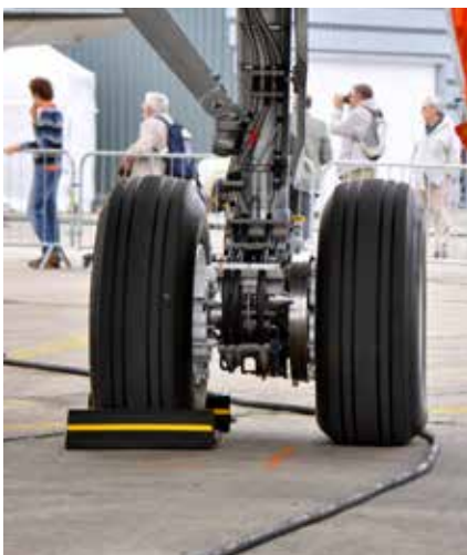
A320 understell med elektromotor
