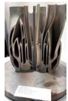
Et brennkammer 3D printet i inconel 718 til en raketmotor.
