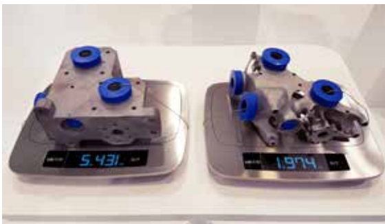
En hydraulisk forlengningsmanifold 3D-printet i titan med en tilsvarende CNC-maskinert i titan.
